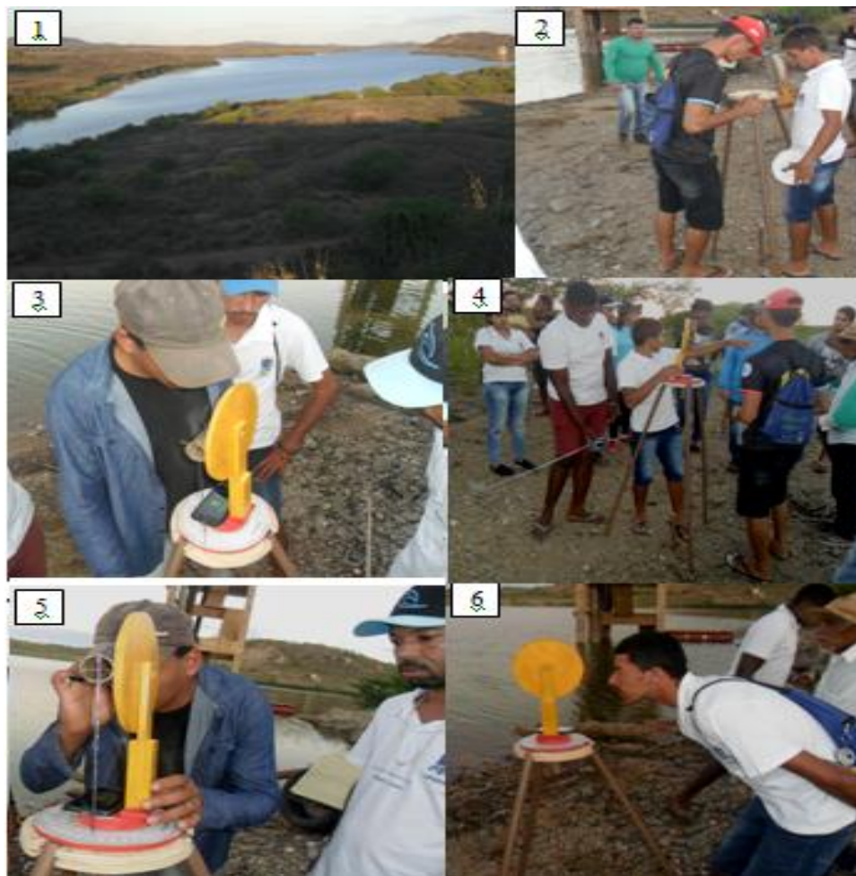
Figura 32 – Determinação da altura da torre de monitoramento do nível de água do Açude Poço da Cruz/PE com o Teodolito Alternativo.
