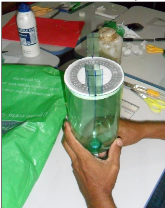
Figura 5.0 – Transferidor sendo utilizado para demarcar a garrafa.
