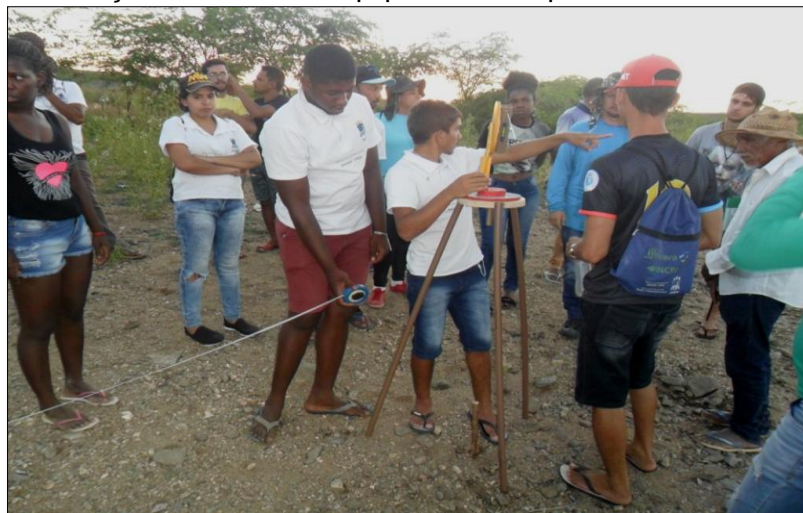
Figura 58 – Determinação distância do equipamento ao ponto escolhido.
