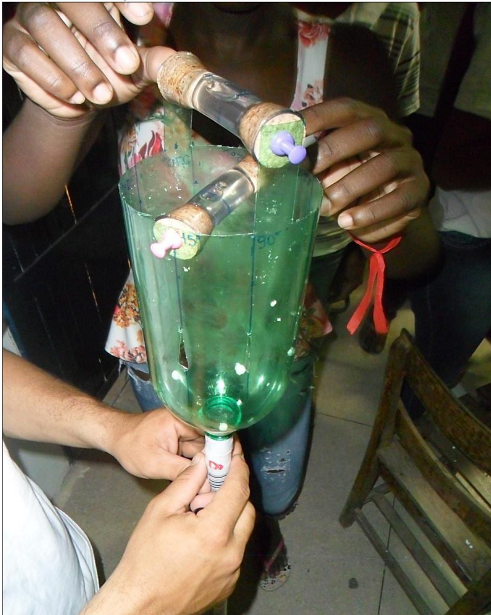
Figura 8.0 - Esquadro de agrimensor montado.
