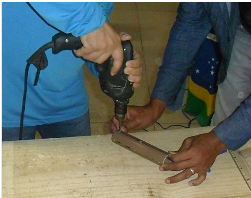
Figura 45 – Perfuração dos pontos por onde irão passar os pregos e o raio de bicicleta.
