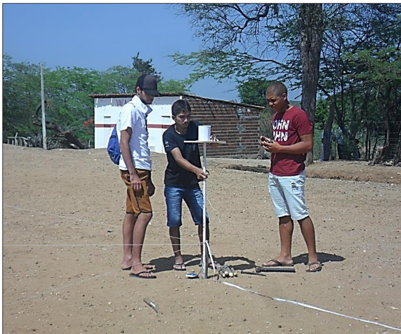
Figura 21 – Demarcação da área com o pantômetro de lata.
