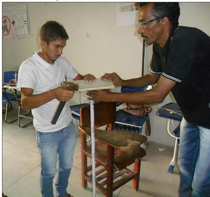
Figura 16 – Fixação da base do pantômetro no cabo de vassoura.
