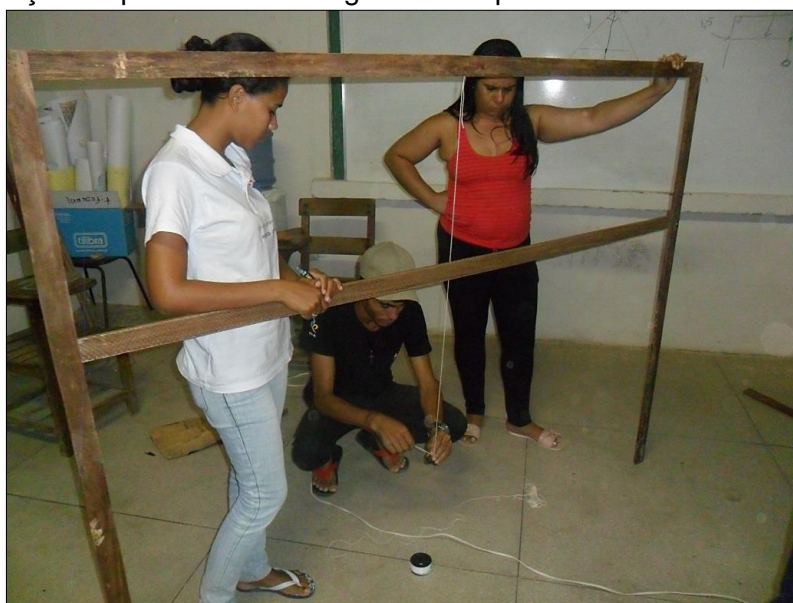
Figura 31 – Fixação do pêndulo e calibragem do Esquadro em Forma de Trave.
