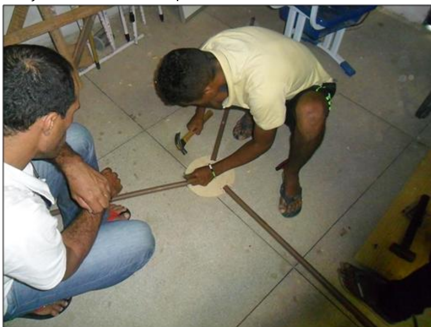
Figura 48 – Fixação dos canos ao compensado.
