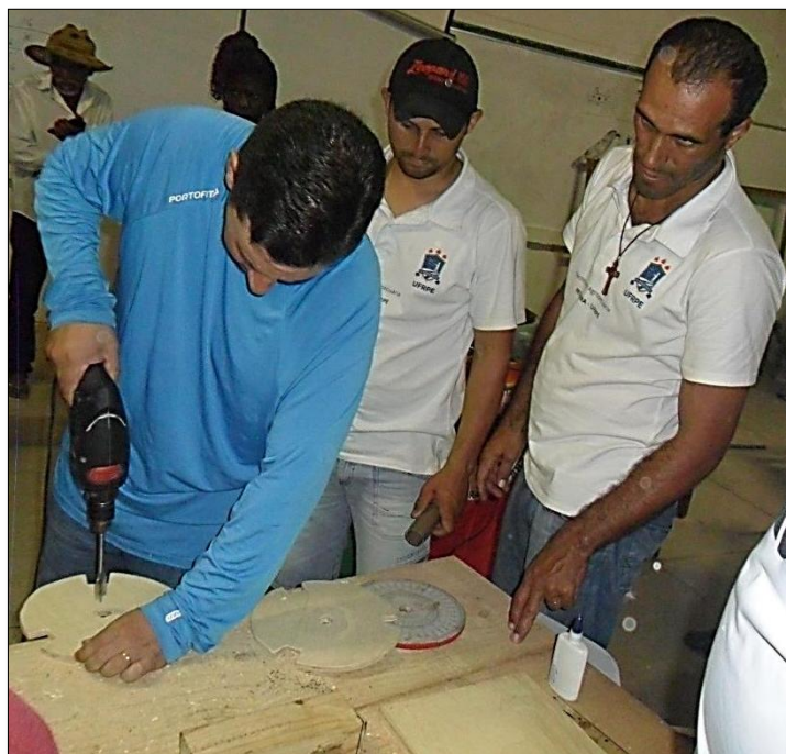
Figura 47 – Usinagem das duas peças que receberão os três canos e o teodolito.
