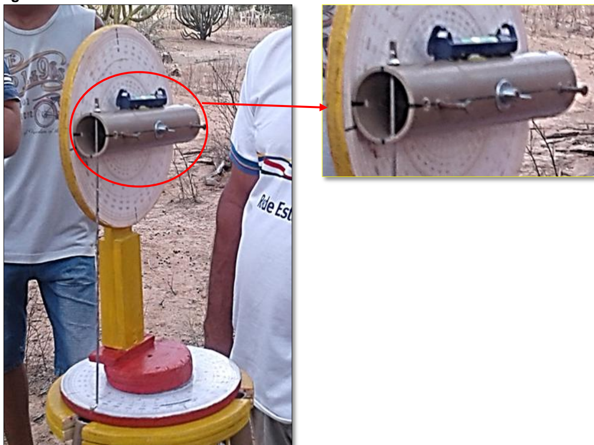
Figura 46 – Detalhe da mira.
