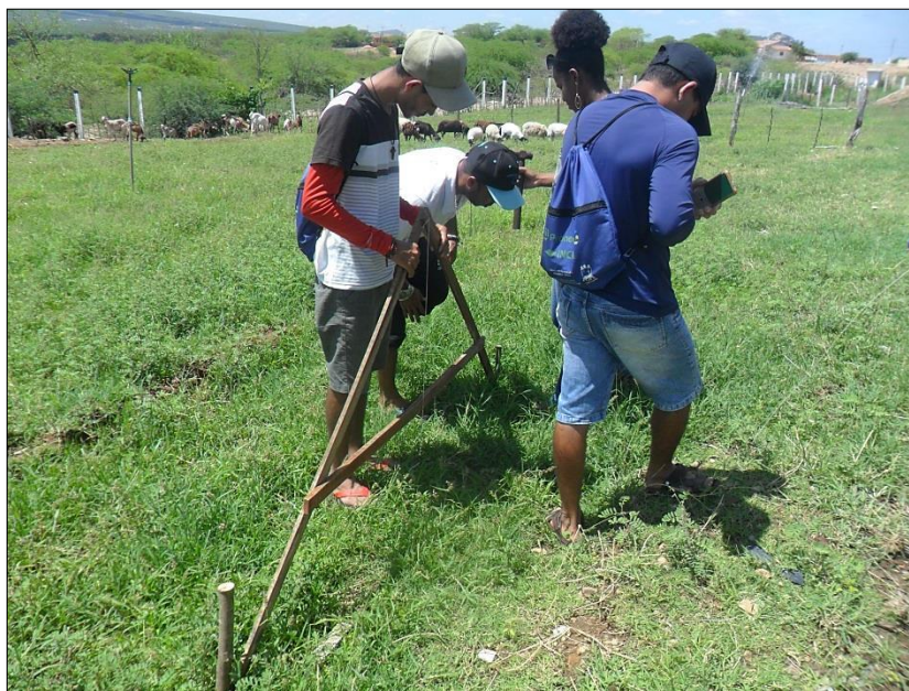
Figura 37 – Determinação da Curva de Nível.
