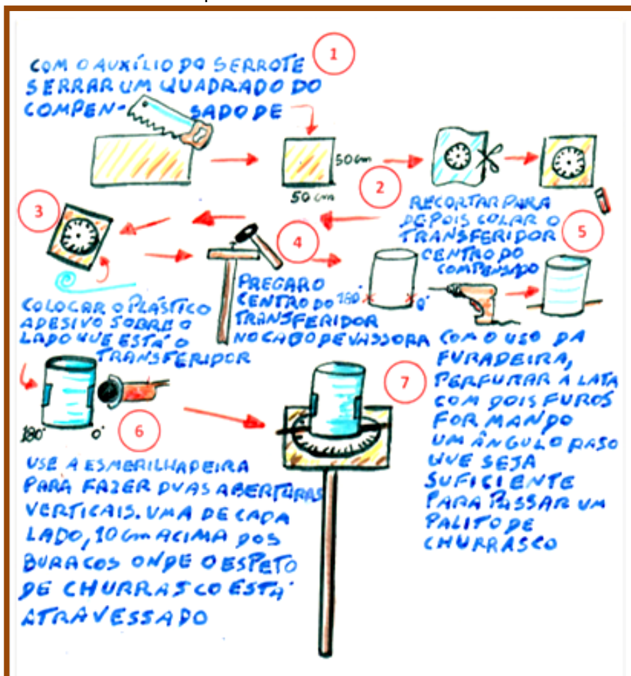
Figura 18 – Desenho elaborado pelo autor detalhado de como é feito o Pantômetro de lata.
