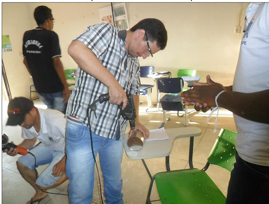
Figura 14 – Abertura dos buracos por onde irá atravessar o palito de churrasco.
