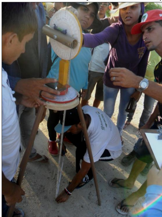
Figura 57 – Centralização, nivelamento e medição da altura do equipamento.
